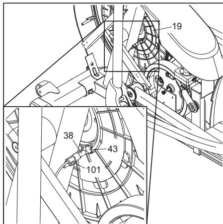
Затем ослабьте, но не снимайте, указанный винт M4 x 16 мм (101). Немного переместите геркон (38) от или к магниту (43), а затем затяните винт. Затем качните шкив (19) вперед и назад так, чтобы магнит проходил шкив последовательно.
