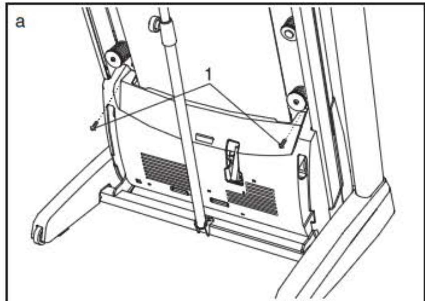
Разложите беговую дорожку (см. КАК ПОДГОТОВИТЬ ТРЕНАЖЁР К РАБОТЕ на стр. 28). Выкрутите три винта M4 x 19 мм (1). Аккуратно снимите кожух мотора (71).
