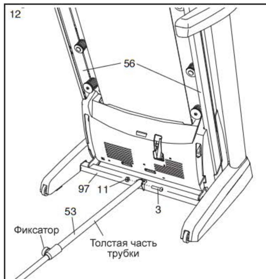
13. Верхний конец трубы (53) прикрепите к раме (56) с помощью болта M10 x 44,5 мм (6) и гайки M10 (11). Важно: чтобы состыковать телескопическую трубку с рамой, возможно, придётся подвигать раму вперёд-назад.
