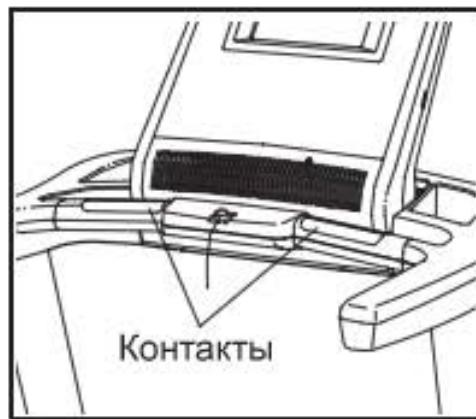
Чтобы измерить частоту биений своего сердца, встаньте на боковые ограждения и положите ладони на металлические контакты чувствительной полосы секунд на десять; ладони при этом не сдвигайте. Когда ваш пульс будет измерен,
