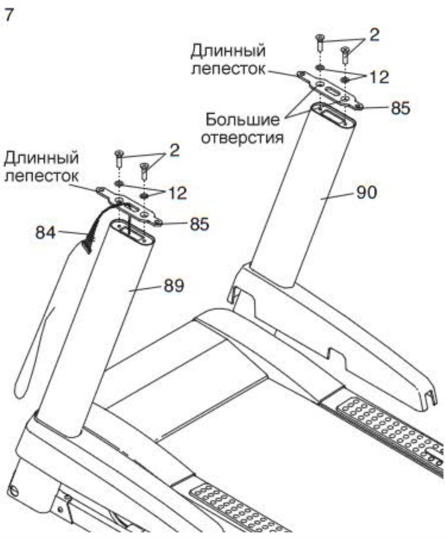
8. Возьмите блок поручней вдвоём и поднимите его над левой стойкой (89).
