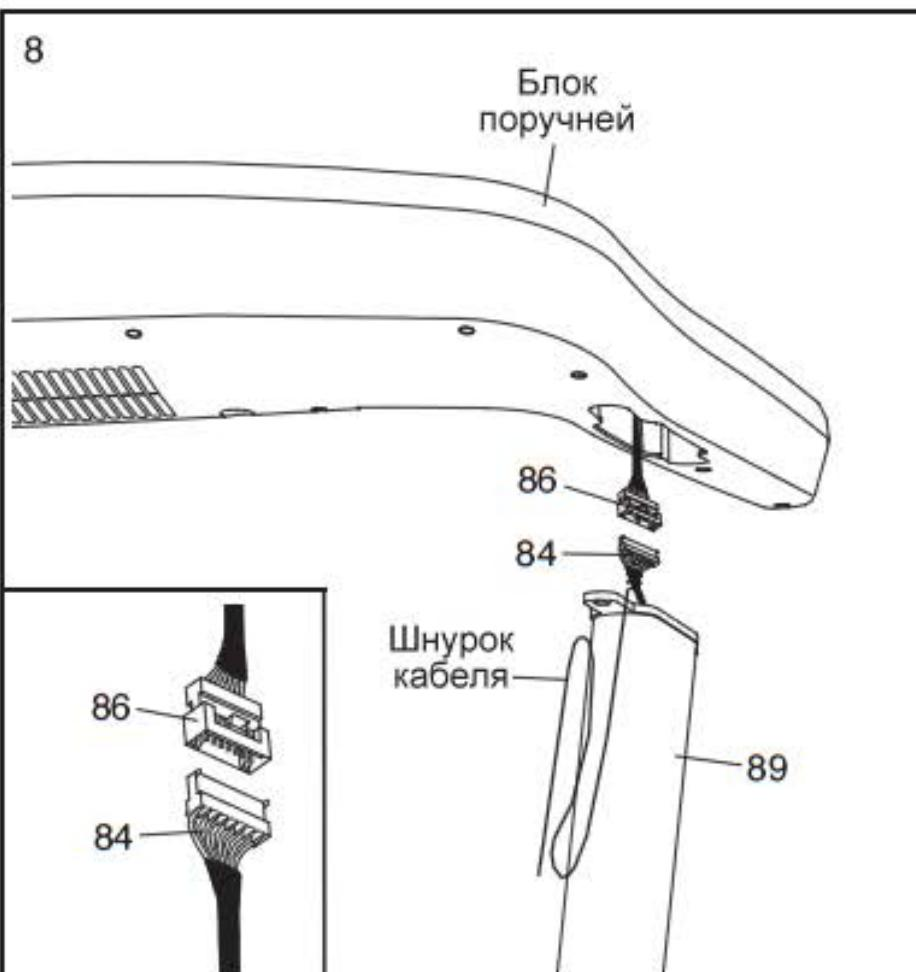
9. При установке блока поручней на стойки (89, 90) вставьте кабели в левую стойку (89). Страйтесь не пережать кабели.
