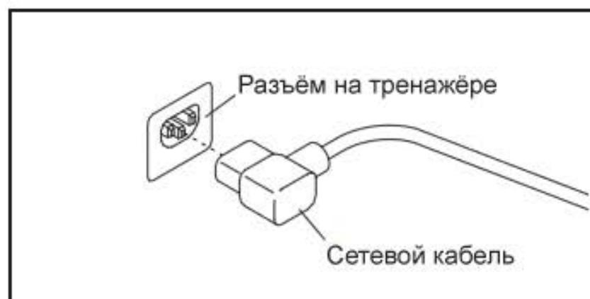
2. Вонкните вилку сетевого шнура в подходящую розетку, установленную и заземлённую в соответствии с местными законами и предписаниями.
