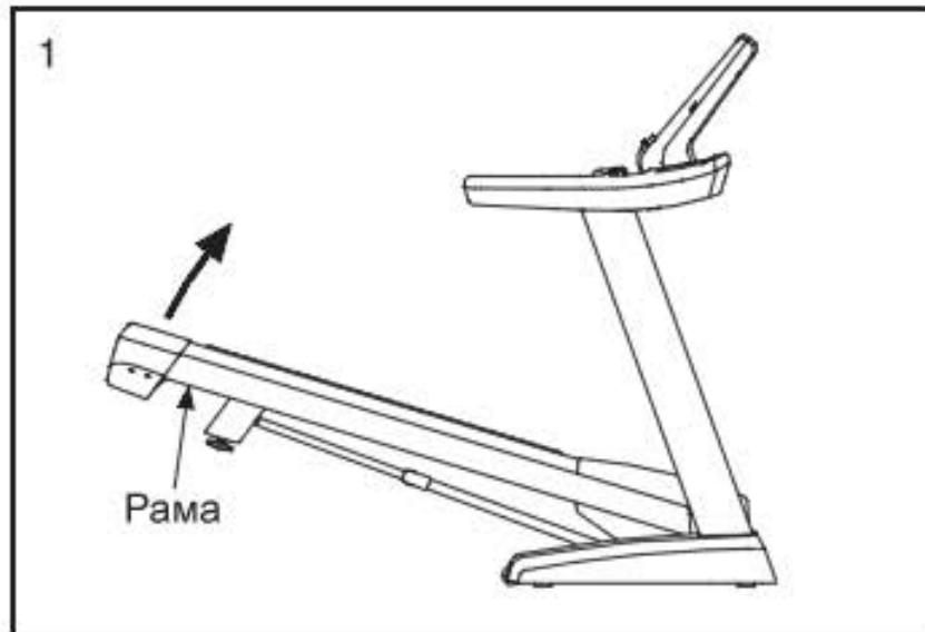
2. Поднимайте раму до тех пор, пока не сработает фиксатор. **ВНИМАНИЕ:** Убедитесь, что фиксатор сработал.
