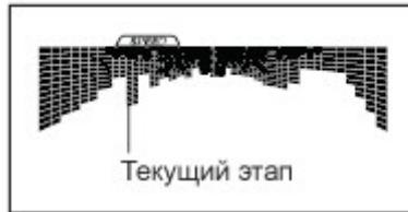
графика обозначает текущий этап тренировки. Высота сегмента отражает значение скорости или наклона для данного этапа. В конце каждого этапа звучит несколько гудков, и начинает мигать следующий сегмент. Если для следующего этапа заданы отличные от предыдущих значения скорости и/или наклона, эти значения будут мигать на дисплее, и беговая дорожка автоматически переключится на них.
