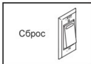
**ВАЖНО:** Когда беговая дорожка выставляется в магазине, дисплеи панели управления работают в демо-режиме. Если дисплеи загораются после подключения сетевого кабеля и перевода переключателя в режим «Сброс», значит демо-режим включен. Чтобы его отключить, нажмите и удерживайте несколько секунд кнопку Stop. Если дисплеи продолжают работать, см. ИНФОРМАЦИОННЫЙ РЕЖИМ на стр. 23.
