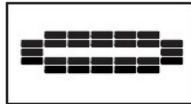
**Дисплей калорий/наклона** — Здесь будет показано примерное число сожжённых калорий, а также наклон беговой дорожки (на несколько секунд в момент изменения наклона).
