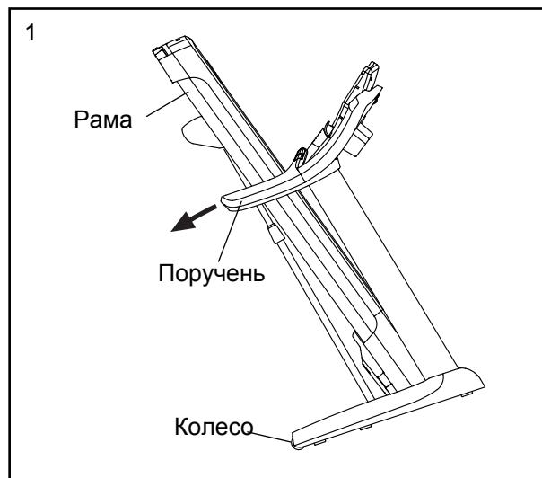
2. Потяните беговую дорожку в противоположную от поручней сторону и катите её на колесах, таким образом перемещая её в нужное место. **ВНИМАНИЕ:** не двигайте беговую дорожку, не наклоняя её назад, не тяните за каркас, и не передвигайте беговую дорожку по неровной поверхности.
